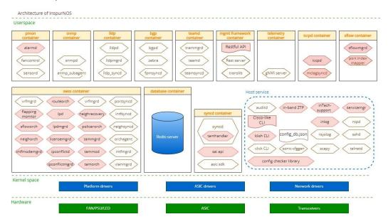
Inspur NOS 在架构上充分考虑了用户使用的安全性,在设计中也融入了安全性方案,并遵循三层三面的安全隔离机制,管里面、控制面和转发面隔离,保证任何平面遭受攻击,其它平面不受影响。Inspur NOS 实现软硬件解耦,可以适配不同的硬件平台,同时适配硬件平台相关安全设计。Inspur NOS 安全架构如图 4-2。
